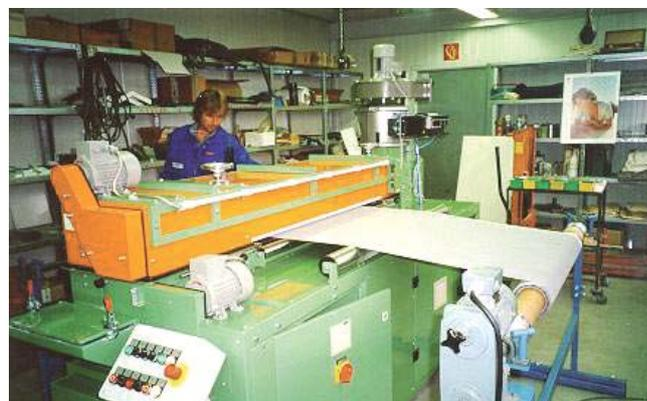
Nach erfolgter Bepudern und Abbürsten des überschüssigen Puders verlässt die Bahn die Maschine mit einer gleichmäßig fein bepuderten Oberfläche.
