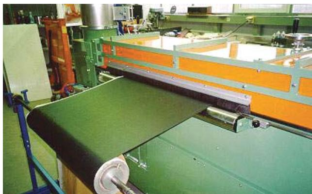
Dieses Photo zeigt den Eintritt der kalandrierten Bahn in die Maschine.
